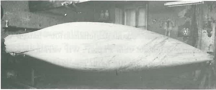
schliffen den Rahmen auf Kontur und füllten die Zwischenräume mit Styroporplatten. Es folgte die wohl wichtigste Arbeit für eine wellenfreie Kontur: die Schleif- und Strakararbeit an der Styroporoberfläche.
