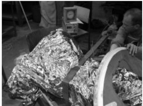
Am 20.04.2005 haben wir den ersten Teil dieses Nachweises durchführen können. In der Werkstatt der Akaflieg haben wir erstmalig die Belastungen an der rumpfseitigen Aufhängung des Tankes simuliert und das mit Erfolg. Der Tank selber wird in einer eigens für ihn gebauten Vorrichtung, den nach JAR geforderten Lasten unterworfen. Diesen Versuch können wir hoffentlich in den nächsten Wochen angehen.
