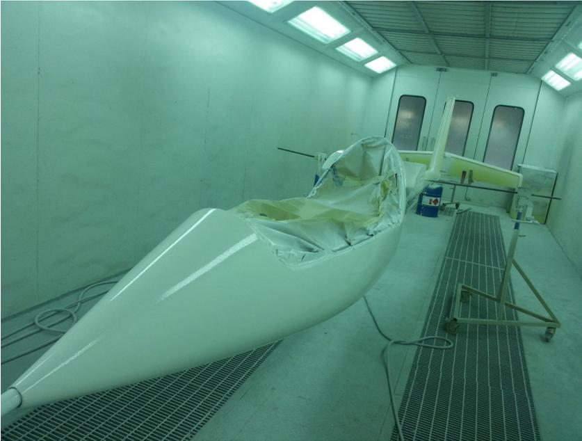
**Abbildung 3:** Die B12 wird lackiert
