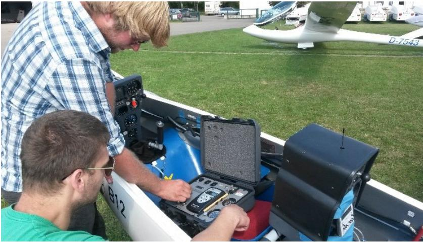
**Abbildung 9:** Versuche mit dem Winter IPK09 Pitot-Statik-Tester
