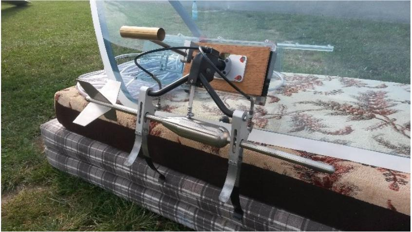
**Abbildung 10:** Kielsches Rohr und DFS60-Schleppsonde
