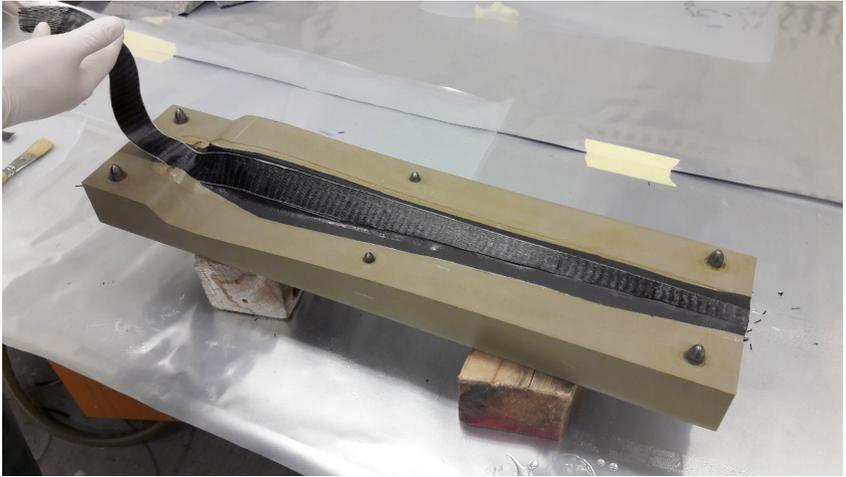
**Abbildung 15:** Einlegen der UD-Gurte in die Propellerschalen
