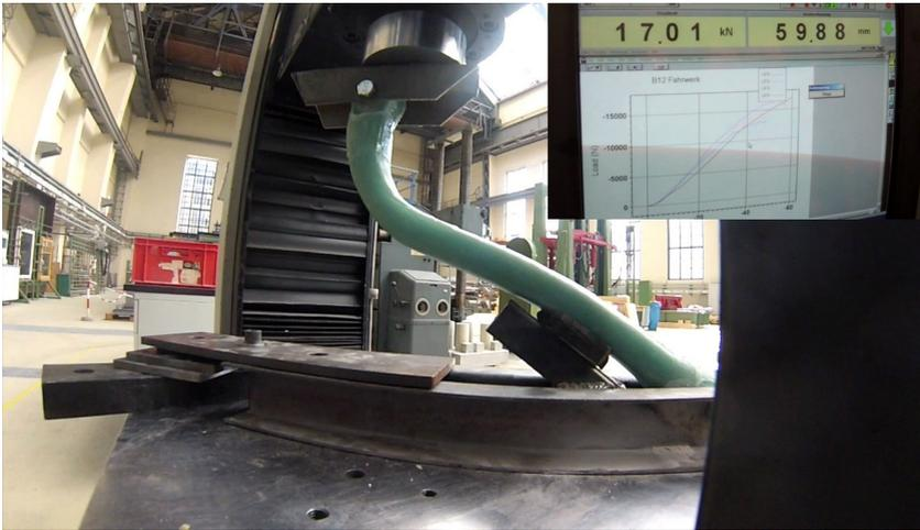
**Abbildung 5:** Bruchversuch der GfK-Fahrwerksschwinge
