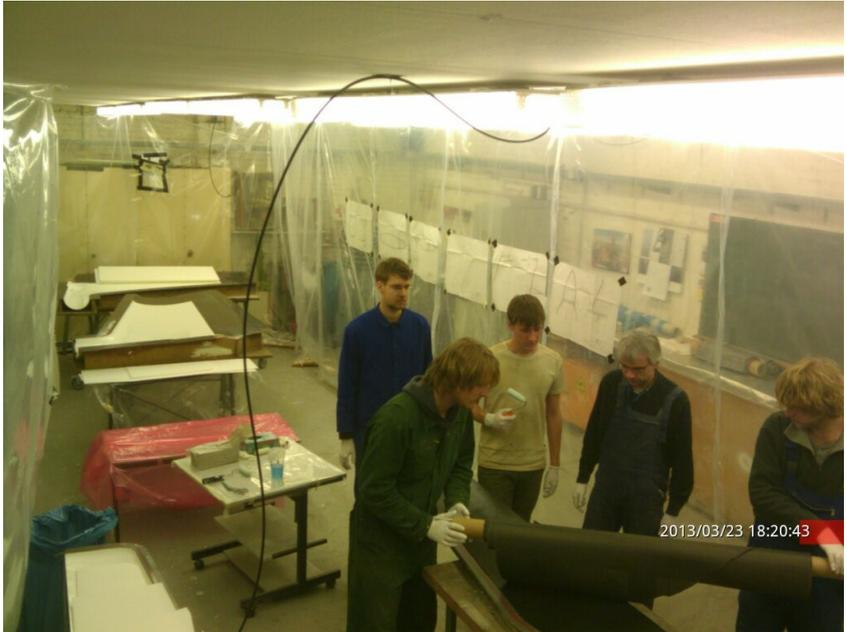
**Abbildung 8:** Einlegen von Seiten- und Höhenleitwerk
