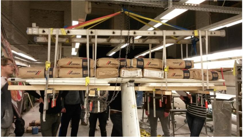
**Abbildung 4:** Belastungsversuch des neuen Höhenleitwerks
