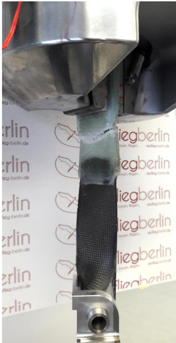
Abbildung 8: Versuchsanordnung nach dem Zugversuch
