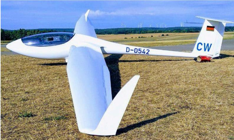
**Abbildung 25:** Direkter Vergleich von großem und kleinem Winglet
