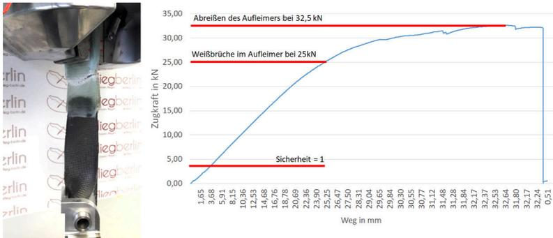
**Abbildung 5:** Belastungsversuch Propeller
