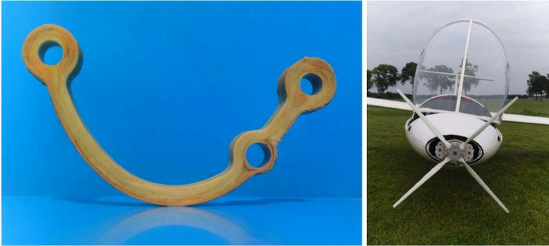
**Abbildung 3:** Probstück der Aramid-Glasfaser-Fahrwerksschwinge (links) und CFK-Vierblatt-*Hofmann*-Faltpropeller an der B13<sup>4</sup>
