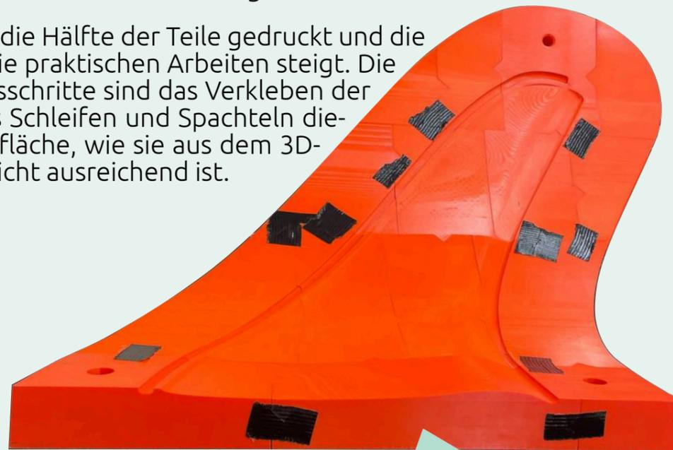
**NOCH WIRD DIE FORM MIT TAPE ZUSAMMENGEGHALTEN. BALD SOLL EIN PROBE-WINGLET DARAUS GEBAUT WERDEN**
